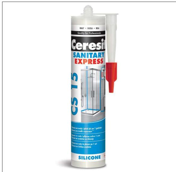
suprafețelor cu banda de mascare, etanșantul se aplică cu pistolul, se finisează în maxim 5-10 minute. Spatulă de finisare se scufundă în prealabil în apă cu săpun. Banda folosită pentru mascare este îndepărtată imediat. Materialul neîntărit trebuie curățat folosind un solvent. Materialul întărit poate fi îndepărtat cu materiale abrazive sau prin alte mijloace mecanice.
